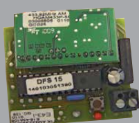
Récepteur pour commande à distance (également disponible en boîtier)
