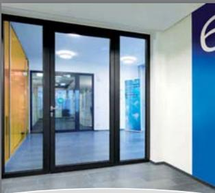
**Feuer- und Rauchschutzabschlüsse in Profilrahmenkonstruktion**
